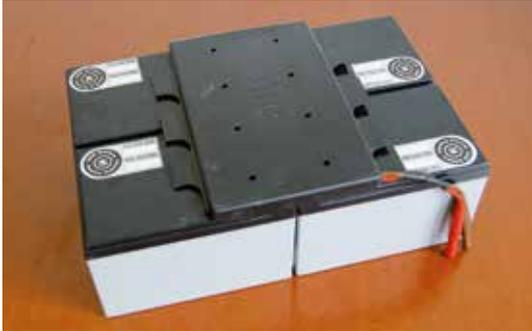
12. Legen Sie den Tragegriff auf und bringen Sie die 2 Kabelbinder wie in der Abbildung an. Achten Sie darauf, dass die Kabelbinder durch den Tragegriff geführt werden.
