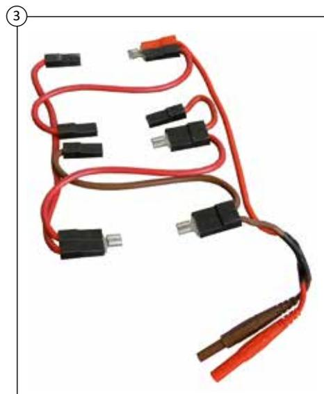
5. Jetzt kann der Kabelsatz (Abb. ③) von allen 8 Batteriepolen abgezogen werden. Legen Sie auch diesen zur Seite, er wird ebenfalls benötigt.
